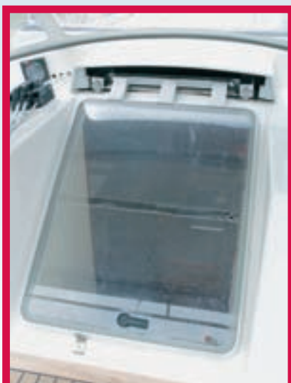
Het geïsoleerde kajuitluik is hermetisch te sluiten. Dat is wel zo prettig als het buiten 70 graden vriest.
