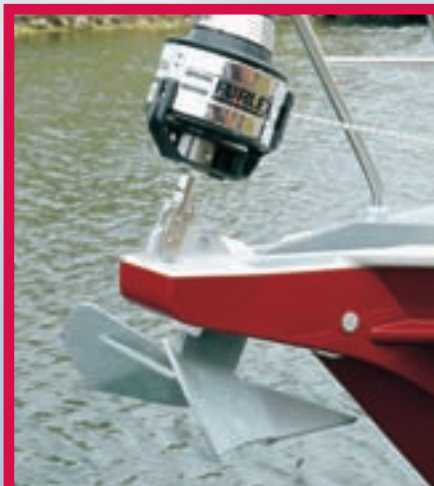
Goede ankers zijn in het poolijs van levensbelang. Vandaar dat er een extra zwaar anker is toegepast, in combinatie met overgedimensioneerd ankerbeslag.
